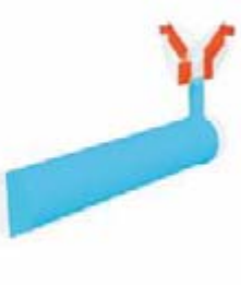
Análise de elementos finitos da pressão estática (pascal) no cabeçote. Note a queda após a câmara comum em formato em V.
