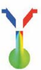
Análise de elementos finitos da turbulência dos componentes através do cabeçote, visualizada usando um método diferente.
