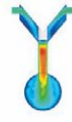
Análise de elementos finitos da velocidade dos componentes através do cabeçote. Note o repentino aumento dos valores (m/s) na câmara de mistura menor
