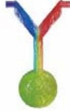
Análise de elementos finitos da turbulência dos componentes através do cabeçote. Note a queda repentina na entrada do duto de descarga.
